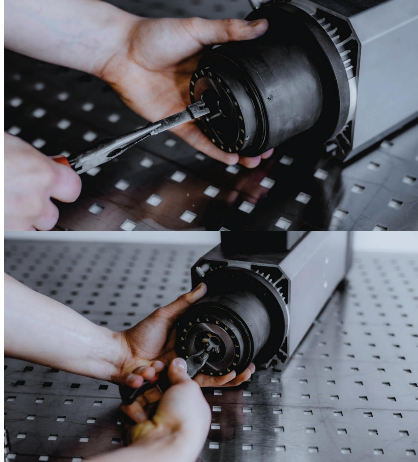
7. Очистить инструментальный конус и корончатую втулку лепестков от продуктов механообработки и смазки
