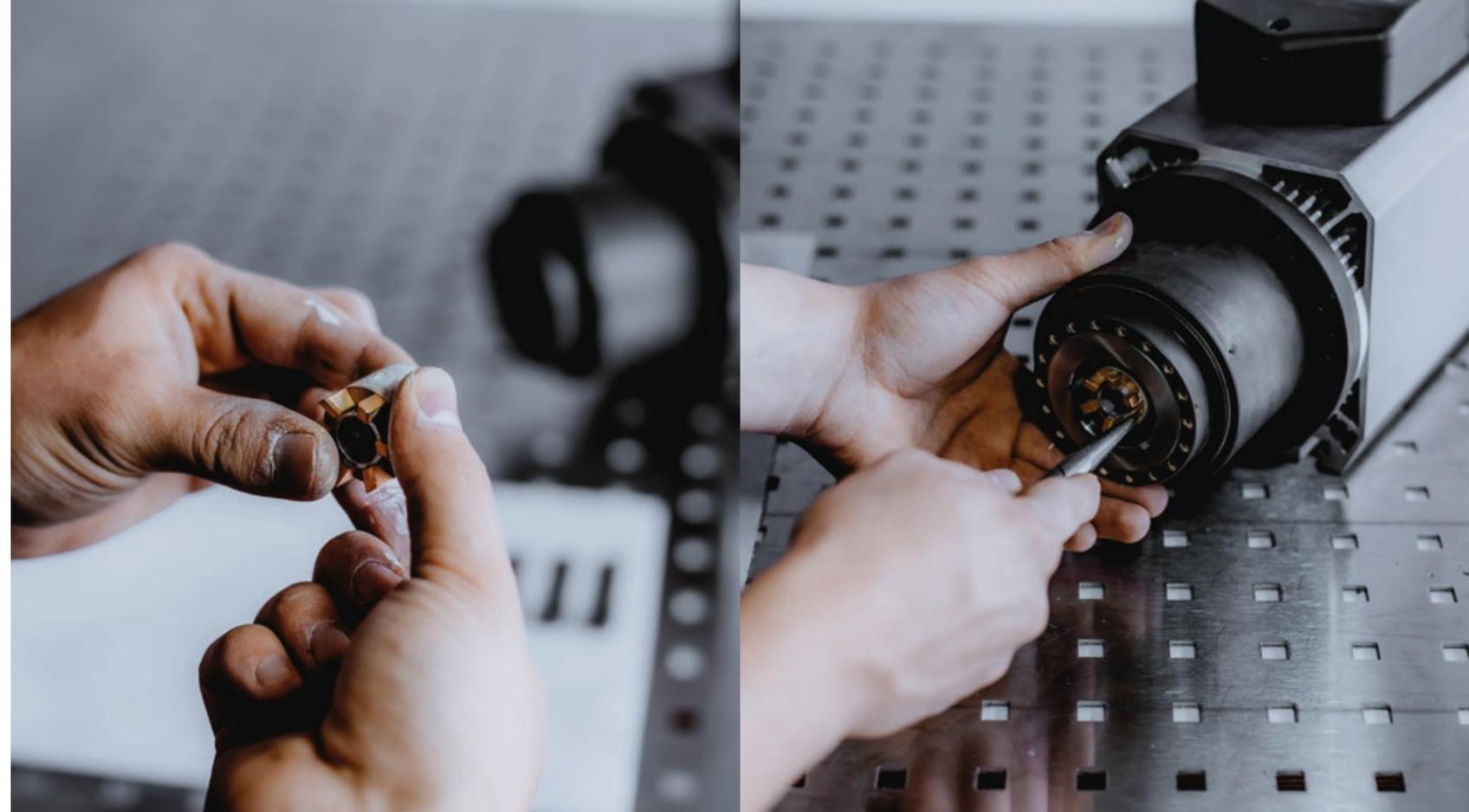
9. Смазать рабочие поверхности и установить лепестки на корончатую втулку внутри конуса
